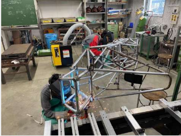
図2:フレーム溶接の様子
